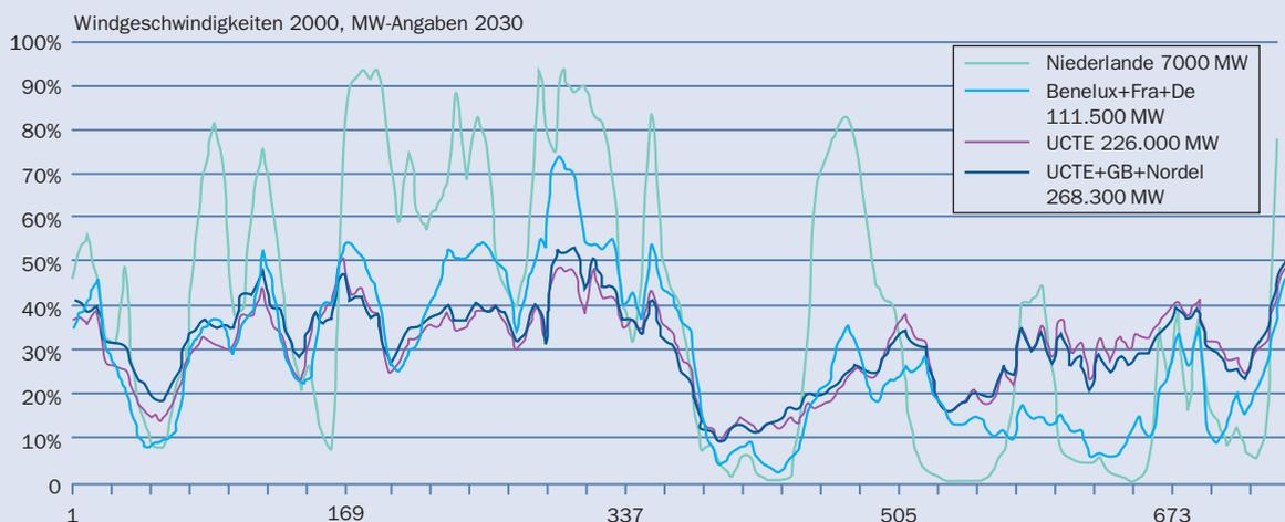
**Anmerkung:** In der Abbildung wird die Windenergieleistung pro Stunde für vier Situationen verglichen. Die Berechnung erfolgte auf Grundlage von simulierter Windenergie. Die Simulationen erfolgten anhand der Windgeschwindigkeiten im Dezember 2000 und der für das Jahr 2030 geschätzten Windenergiekapazitäten.
